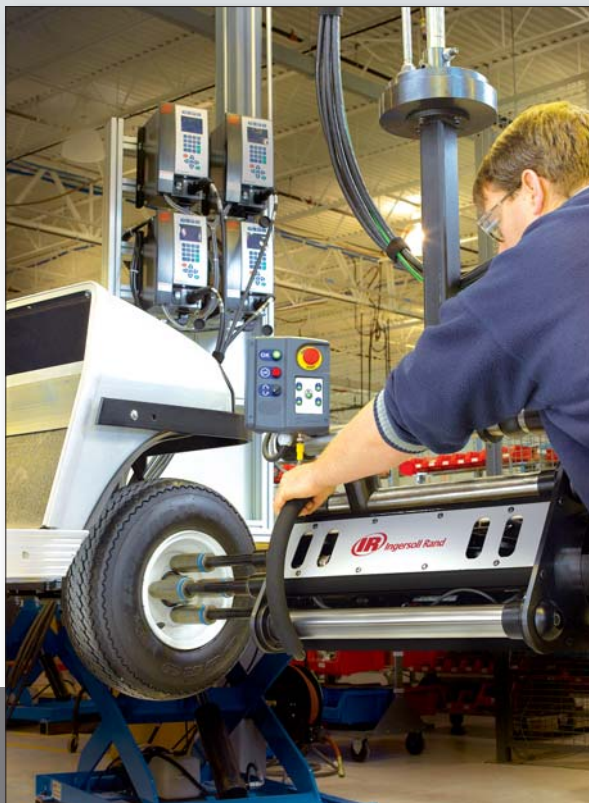
4-шпиндельная горизонтально-поворотная электрическая сборочная система
