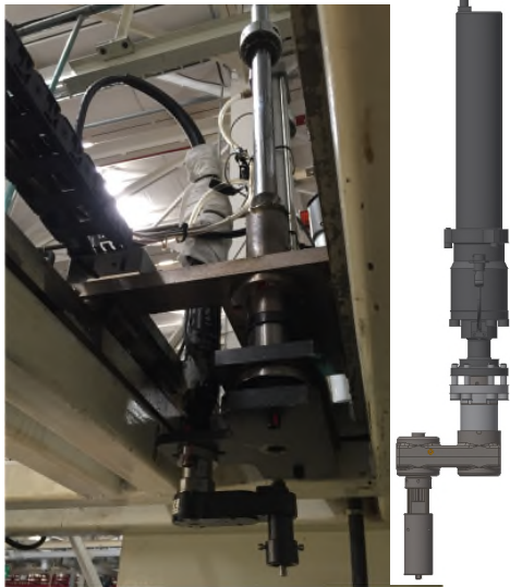
汽车减震器压装工装台 内止外动
