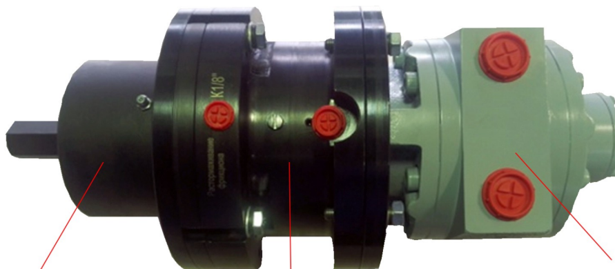
Планетарный редуктор Пневматический тормоз ARB71 Пневмодвигатель MRV040B5D90
