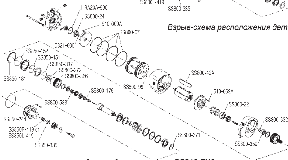
Взрыв-схема расположения деталей из комплекта SS810-TK2
