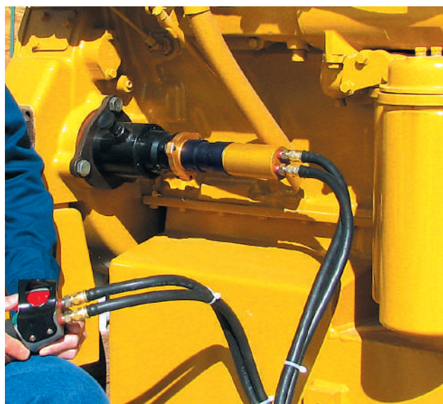
Разгонный двигатель B006PVR374-03-31P с помощью пульта медленно прокручивает двигатель Caterpillar 3408.
