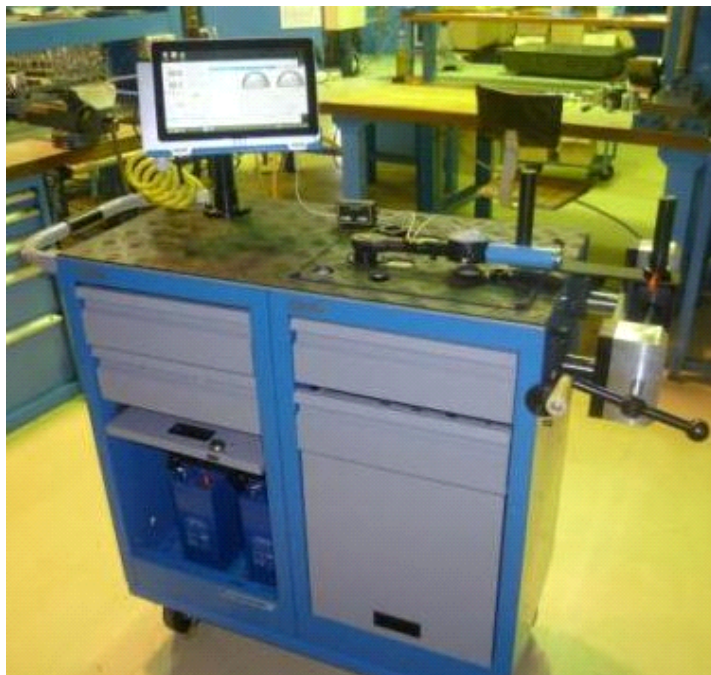
Проверка предельного электронного ключа на стенде ИС 0,5-500
