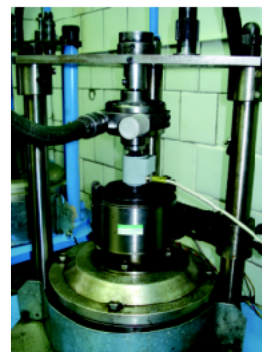
Стенд для испытания пневмодвигателя
